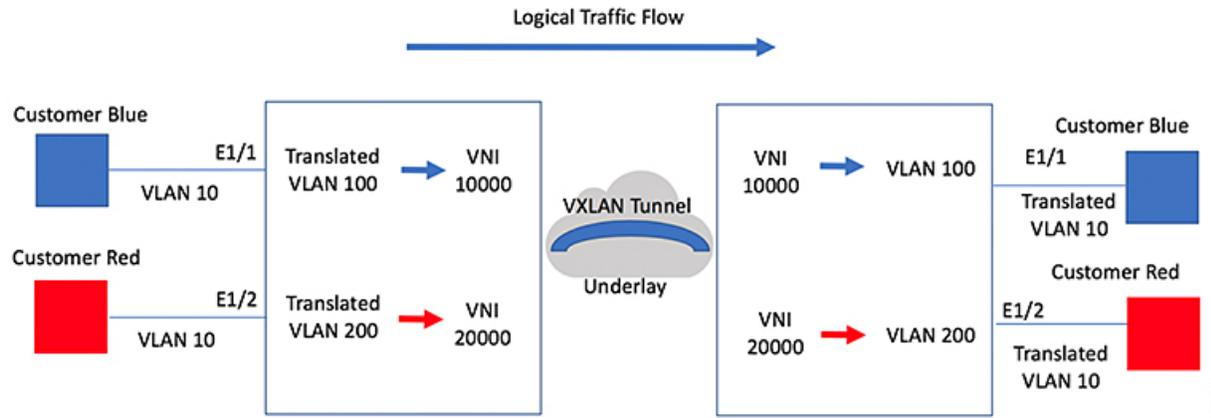
入力（着信）VLAN とポートにあるローカル（変換先）VLAN との間での VLAN 変換を設定できます。VLAN 変換がイネーブルにされたインターフェイスに到着するトラフィックにおいて、着信 VLAN は VXLAN がイネーブルにされた変換先 VLAN にマッピングされます。
