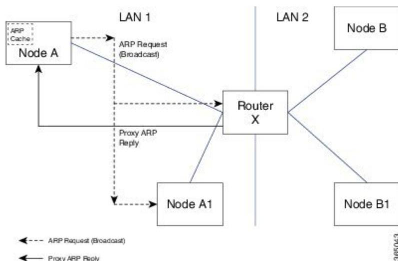
1. エンドシステム Y (ノード A) は ARP 要求を LAN にブロードキャストし、エンドシステム Z (ノード B) の MAC アドレスの学習を試みます。
