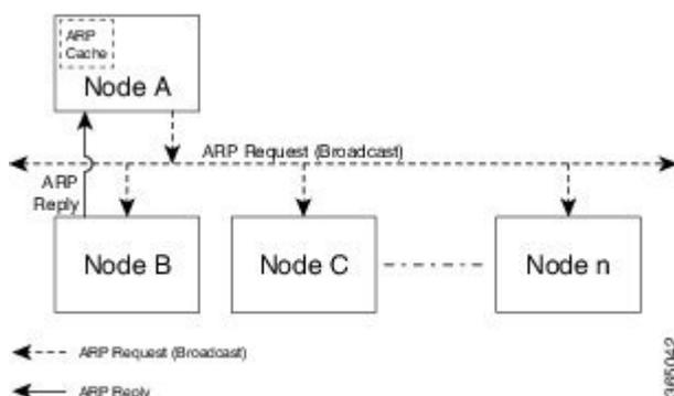
1. エンドシステム A (ノード A) は ARP 要求を LAN にブロードキャストし、エンドシステム B (ノード B) の MAC アドレスの学習を試みます。
