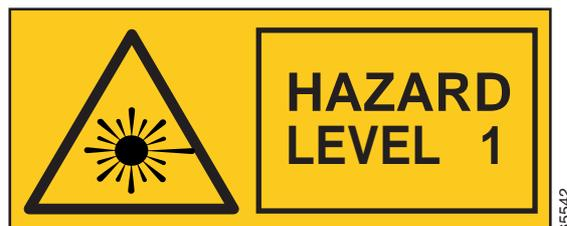
このラベルでは、ユーザが IEC60825-1 Ed.1.2 に従って算出されたクラス 1 限度のレーザー光線にさらされる危険性があることを警告しています。
