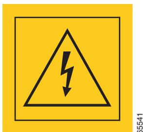
このラベルは、カードの扱いによって感電する危険性を警告しています。感電事故の可能性があるのは、メンテナンス時に隣接カードを取り外す際に、カード上にある電気回路の露出部分に触れた場合です。
