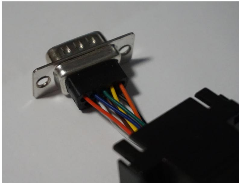
アダプタの DB9 側をコネクタの RJ-45 側に接続されたプラスチックコネクタにはめ込みます。この接続が完了すると、コネクタの使用が可能になります。
