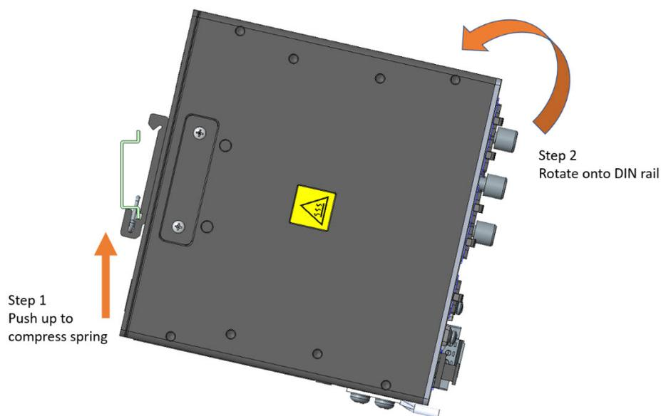
**Step 2** DIN クリップの上部フックが DIN レールの上部に固定されるようにルータを回転させます。次の図を参照してください。
