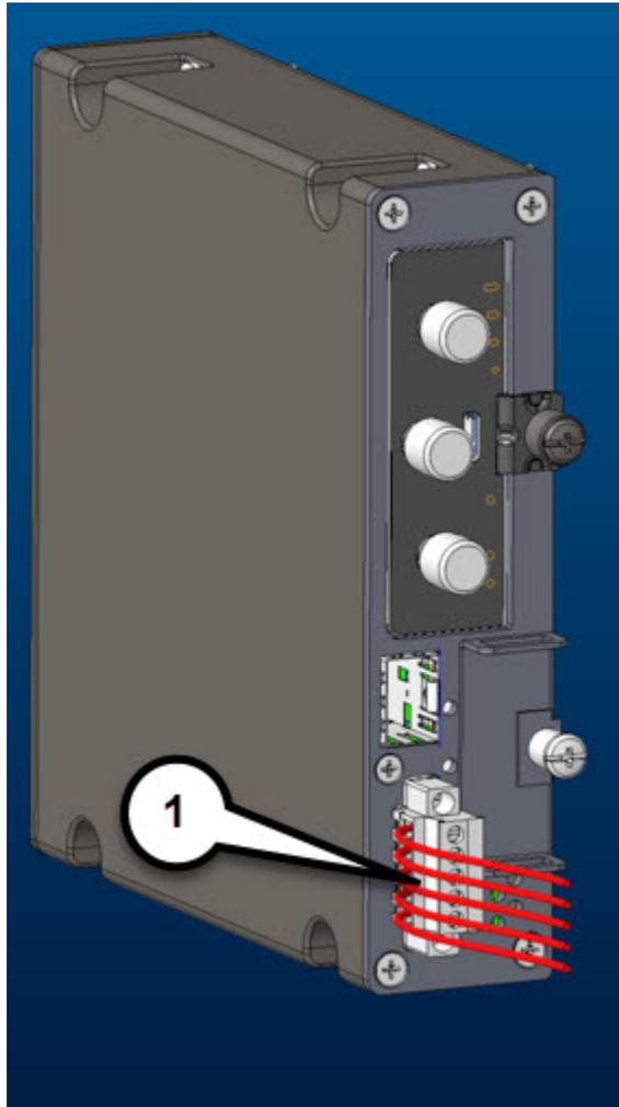
デジタル I/O コネクタには、4つの GPIO 接続と 1つのリターン接続があります。デジタル I/O のデフォルトの状態は Input（入力）であり、オープンコレクタはオープン（オフ）になっています。デジタル I/O コネクタの詳細については、[デジタル I/O コネクタ](#) で参照できます。
