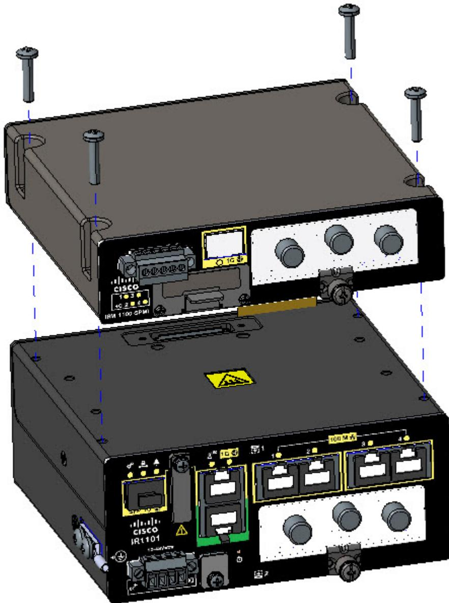
**Step 3** 13～15 インチポンド (1.5～1.7 ニュートンメートル) のトルクでネジを締めます。完了すると、次の図に示すように、2つのデバイスによって1つのアセンブリが形成されます。
