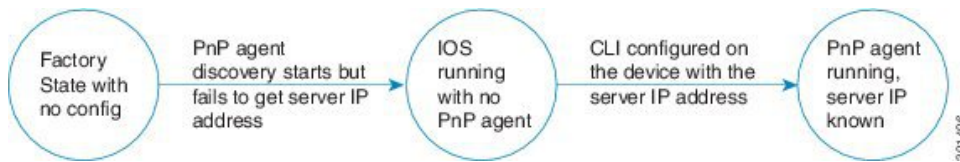
図 55: CLI 設定 PnP プロファイルによる PnP トリガーの状態図
