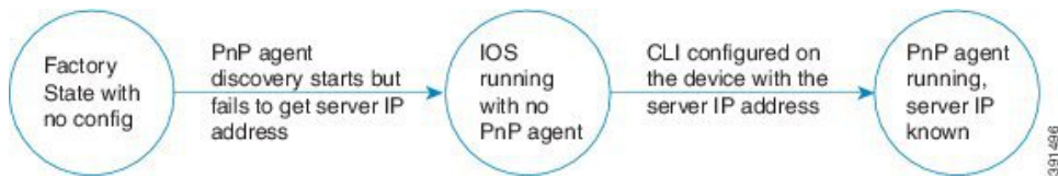
図 4: CLI 設定 PnP プロファイルによる PnP トリガーの状態図
