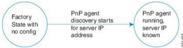
図 3: スタートアップコンフィギュレーションなしの PnP トリガーの状態図
