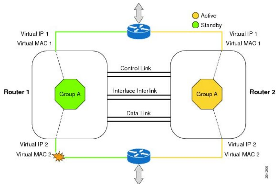
設定可能なコントロールリンクおよびデータ同期リンクによってデバイスが結合されます。コントロールリンクは、デバイスのステータスを通信するために使用されます。データ同期リンクを使ってステートフル情報を転送し、コールとメディアフローに関してステートフルデータベースを同期します。冗長インターフェイスの各ペアは同じ一意のID番号（RIIとも呼びます）で設定されます。デバイスでのシャーシ間HA設定の詳細については、[シャーシ間ハイアベイラビリティの設定（3 ページ）](#) を参照してください。
