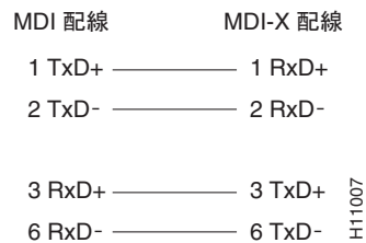
図 1-30 ハブ、リピータ、またはスイッチへのストレート ケーブルのピン割り当て
