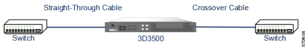
図 2-1 ストレート線のバイパス接続のケーブル配線
