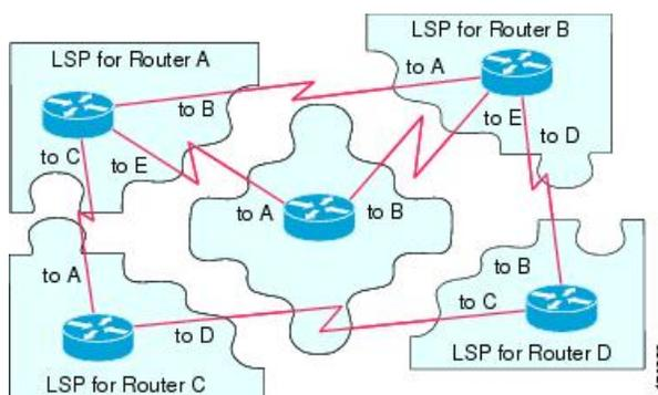
次の図は、ネイバー デバイス間で隣接関係（アジャセンシー）が形成された後に、IS-IS ネットワーク内の各デバイスが完全に更新されたリンクステート デバイスを備えていることを示しています。エリア内のすべてのレベル1 デバイスまたはレベル2 サブドメイン内のすべてのレベル2 デバイ스에適用されます。
