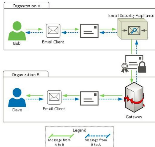
企業 A と B は、両社の間でやり取りするすべてのメッセージを、S/MIME を使用して署名および暗号化したいと考えています。企業 A は、ゲートウェイレベルで S/MIME セキュリティ サービスを実行するように Cisco Secure Email Gateway を設定しています。企業 B は、ゲートウェイレベルで S/MIME セキュリティ サービスを実行するようにサードパーティ アプリケーションを設定しています。
