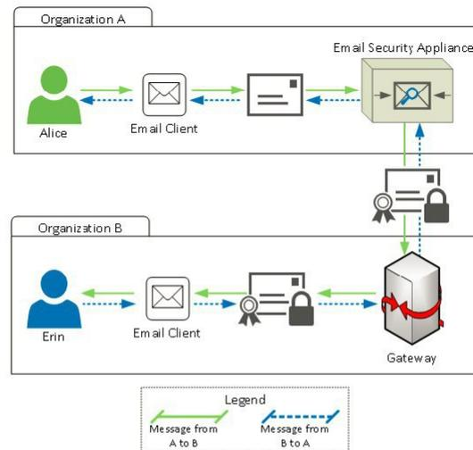
企業 A と B は、両社の間でやり取りするすべてのメッセージを、S/MIME を使用して署名および暗号化したいと考えています。企業 A は、ゲートウェイレベルで S/MIME セキュリティ サービスを実行するように Cisco Secure Email Gateway を設定しています。企業 B は、すべてのユーザの電子メールクライアントを、S/MIME セキュリティ サービスを実行するように設定しています。
