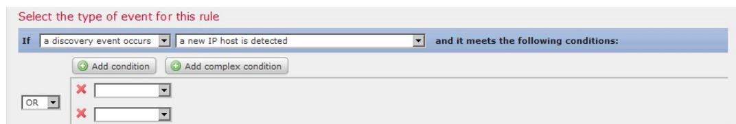
次の図は、単純条件1つと、複合条件1つを [OR] 演算子で結合した相関ルールを示したものです。複合条件は2つの単純条件を [AND] 演算子で結合して構成します。
