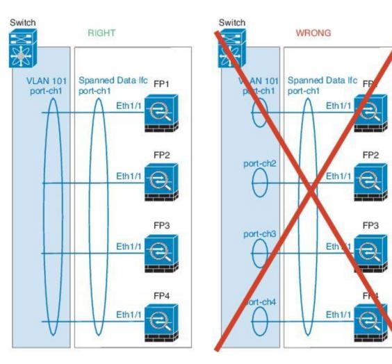
• デバイス ローカル EtherChannel: クラスタ ユニット デバイス ローカル EtherChannel (クラスタ制御リンク用に設定された EtherChannel もこれに含まれます) は、それぞれ独立した EtherChannel としてスイッチ上で設定してください。スイッチ上で複数のクラスタ ユニット EtherChannel を結合して1つの EtherChannel としないでください。
