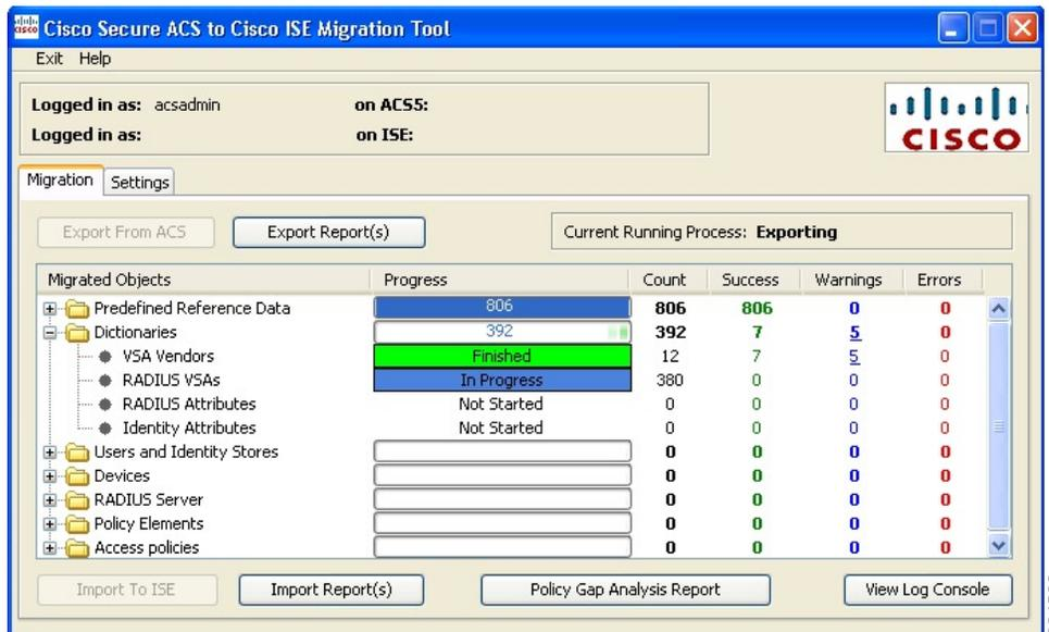
**ステップ 6** エクスポート プロセスで発生した警告またはエラーについて詳しい情報を取得するには、[移動 (Migrations)] タブの [警告 (Warnings)] または [エラー (Errors)] カラムで下線の付いた数字をクリックします。[オブジェクトエラーと警告の詳細 (Object Errors and Warnings Details)] ウィンドウに、エクスポート中に発生した警告またはエラーの結果が表示されます。警告またはエラーのオブジェクトグループ、タイプ、および日時が示されます。
