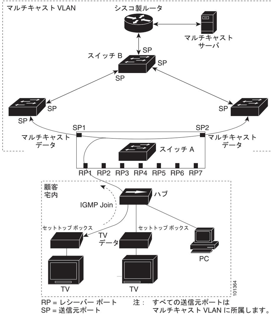
加入者がチャンネルを切り替えた場合、またはテレビのスイッチを切った場合には、セットトップボックスからマルチキャストストリームに対する IGMP Leave メッセージが送信されます。スイッチの CPU は、レシーバーポートの VLAN 経由で MAC ベースの一般クエリを送信します。VLAN に、同じグループに加入している別のセットトップボックスがある場合、そのセットトップボックスはクエリに指定された最大応答時間内に応答しなければなりません。応答を受信しなかった場合、CPU はそのグループの転送先としてのレシーバーポートを除外します。
