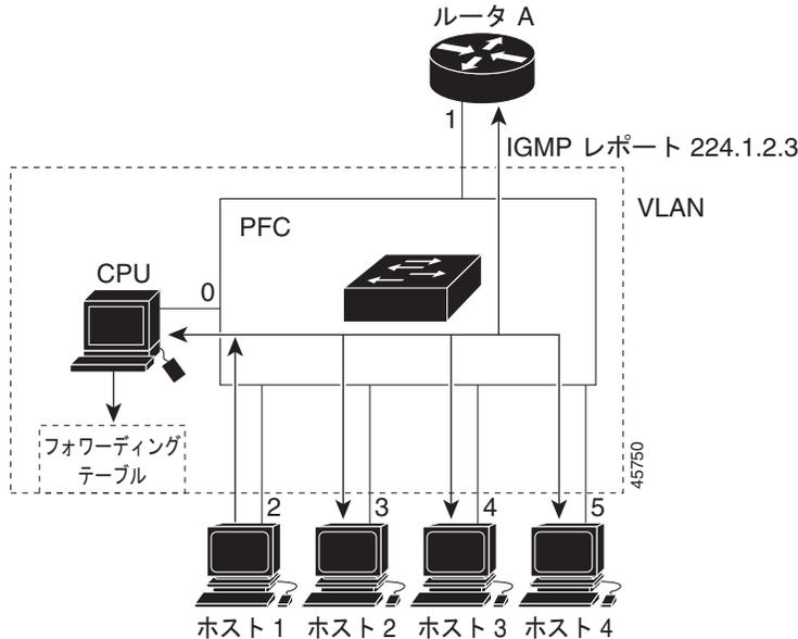
ルータ A からスイッチに一般クエリーが送信されます。スイッチによってそのクエリーがポート 2 ~ 5 に転送されます。これらのポートは、すべて同じ VLAN のメンバーになっています。ホスト 1 はマルチキャスト グループ 224.1.2.3 に加入するために、グループに IGMP メンバシップ レポート (IGMP Join メッセージ) をマルチキャストします。スイッチの CPU では、IGMP レポート内の情報を使用して、ホスト 1 とルータに接続されているポート番号を含む転送テーブル エントリ (表 21-1 を参照) が設定されます。
