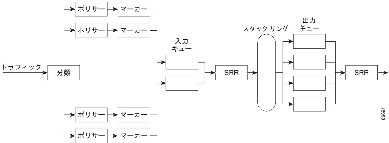
すべてのポートの入力帯域幅の合計がスタック リングの帯域幅を超えることがあるため、入力キューはパケットの分類、ポリシング、およびマーキングの後、パケットがスイッチ ファブリックに転送される前の位置に配置されています。複数の入力ポートから 1 つの出力ポートに同時にパケットが送信されて、輻輳が発生することがあるため、出力キューはスタック リングの後に配置されています。
