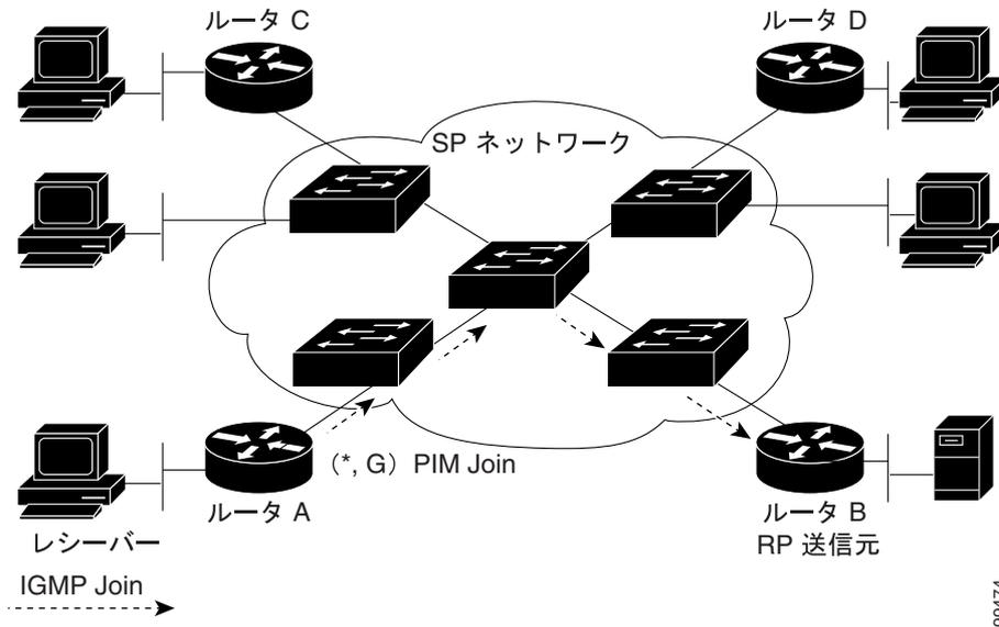
図 32-3 では、PIM スヌーピングがイネーブルでない場合のデータトラフィックフローを示します。この図では、スイッチはルータ A を対象としたデータトラフィックを接続されたすべてのルータにフラッドします。
