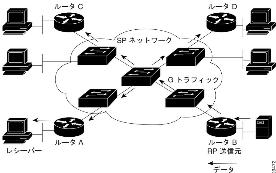
図 32-4 では、PIM スヌーピングがイネーブルの場合のデータトラフィックフローを示します。この図では、スイッチはデータトラフィックを受信する必要があるルータ（ルータ A）にのみ転送します。
