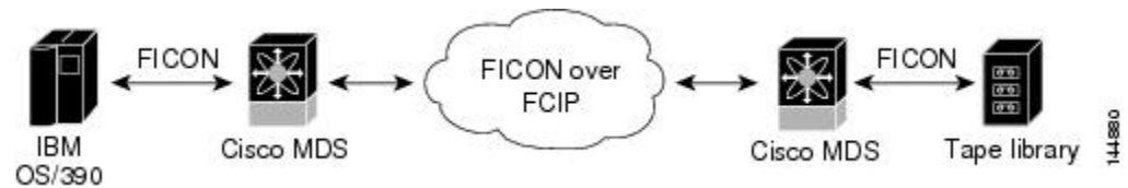
図 59 : スタンドアロン IBM-Virtual Tape Server (VTS) /STK-Virtual Shared Memory (VSM) にアクセスするホスト
