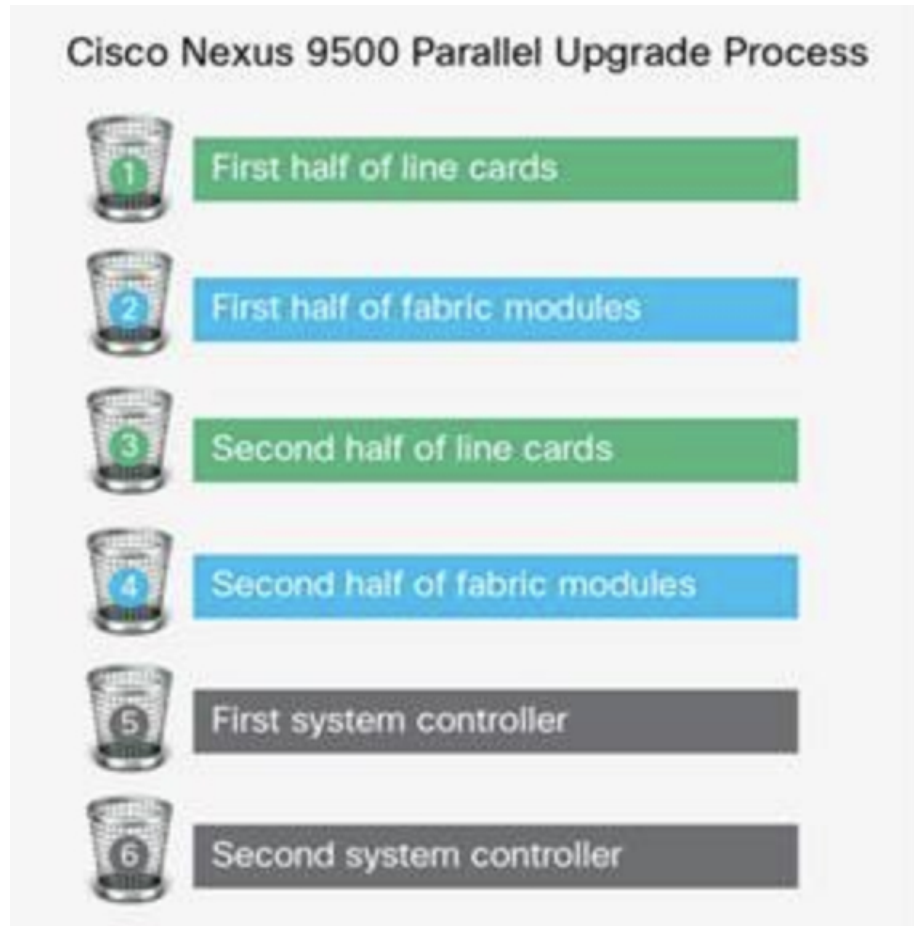
図 1: Cisco Nexus 9500 シリーズスイッチの並行アップグレードプロセス
