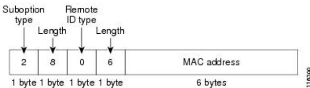
図「ユーザ設定のサブオプションのパケット形式」は、ユーザ設定のリモート ID サブオプション、および回線 ID サブオプションのパケット形式を示しています。デバイスでは、DHCP スヌーピングをグローバルに有効にし、**ip dhcp snooping information option format remote-id** コマンド、および**ip dhcp snooping vlan information option format-type circuit-id string** コマンドを入力した場合に、これらのパケット形式が使用されます。
