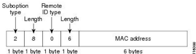
図「ユーザ設定のサブオプションのパケット形式」は、ユーザ設定のリモート ID サブオプション、および回線 ID サブオプションのパケット形式を示しています。デバイスでは、DHCP スヌーピングをグローバルに有効にし、**ip dhcp snooping information option format remote-id** コマンド、および **ip dhcp snooping vlan information option format-type circuit-id string** コマンドを入力した場合に、これらのパケット形式が使用されます。
