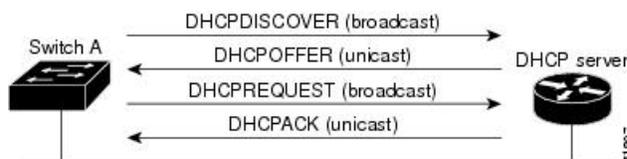
クライアントであるデバイス A は、DHCP サーバの場所を特定するために、DHCPDISCOVER メッセージをブロードキャストします。DHCP サーバは、DHCPOFFER ユニキャストメッセージによって、使用可能なコンフィギュレーションパラメータ (IP アドレス、サブネットマスク、ゲートウェイ IP アドレス、DNS IP アドレス、IP アドレス用のリースなど) をクライアントに提示します。
