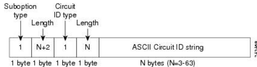
図 1: 回線 ID を指定した場合のサブオプションパケットフォーマット
