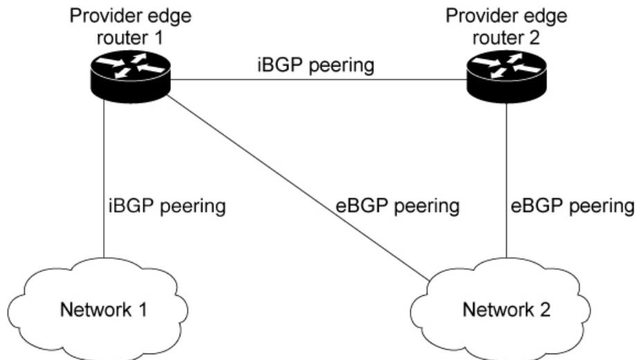
PE ルータ 1 には、MPLS VPN における eBGP および iBGP の両方に BGP マルチパス ロードシェアリング機能が設定でき、これによって、iBGP パスと eBGP パスの両方をマルチパスとして選択し、VRF にインポートできます。マルチパスは CEF によって使用され、ロードバランシングが実行されます。ネットワーク 1 からネットワーク 2 に送信される IP トラフィック
