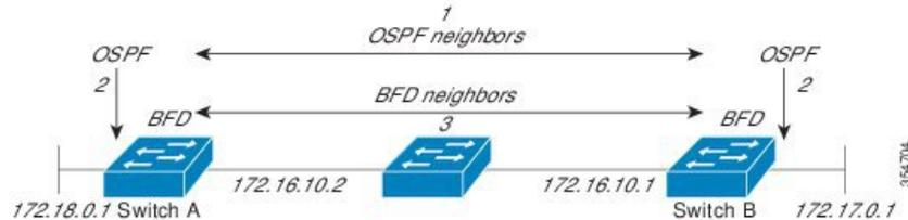
以下の図に、ネットワークで障害が発生した場合を示します (1)。OSPF ネイバルルータでの BFD ネイバーセッションが停止されます (2)。BFD はローカル OSPF プロセスに BFD ネイバーに接続できなくなったことを通知します (3)。ローカル OSPF プロセスは OSPF ネイバー関係を解除します (4)。代替パスを使用できる場合、ルータはただちにコンバージェンスを開始します。
