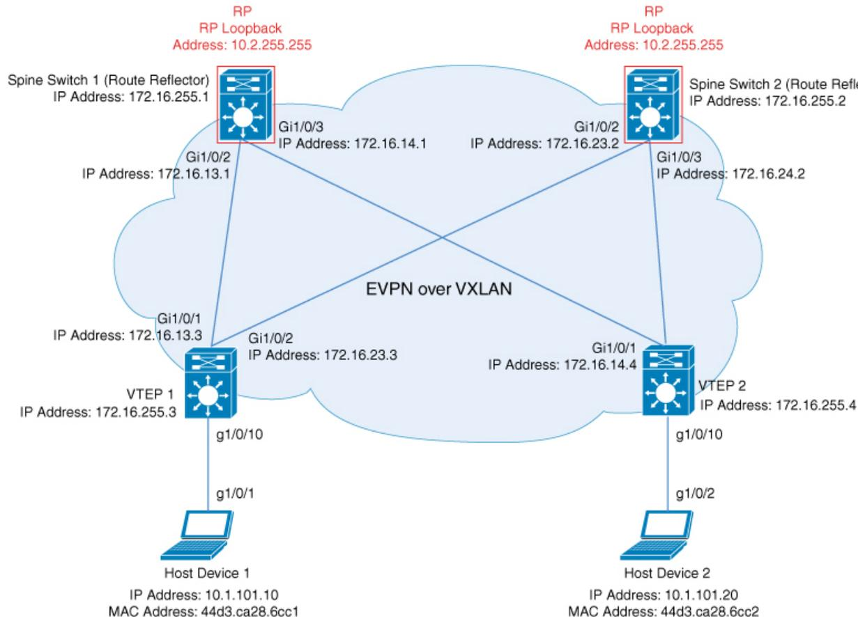
このトポロジは、2台のスパインスイッチ（スパインスイッチ1およびスパインスイッチ2）と2台のVTEP（VTEP1およびVTEP2）を備えたEVPN VXLANネットワークを示しています。マルチキャストレプリケーションは、ネットワーク内のBUMトラフィックを転送するた
