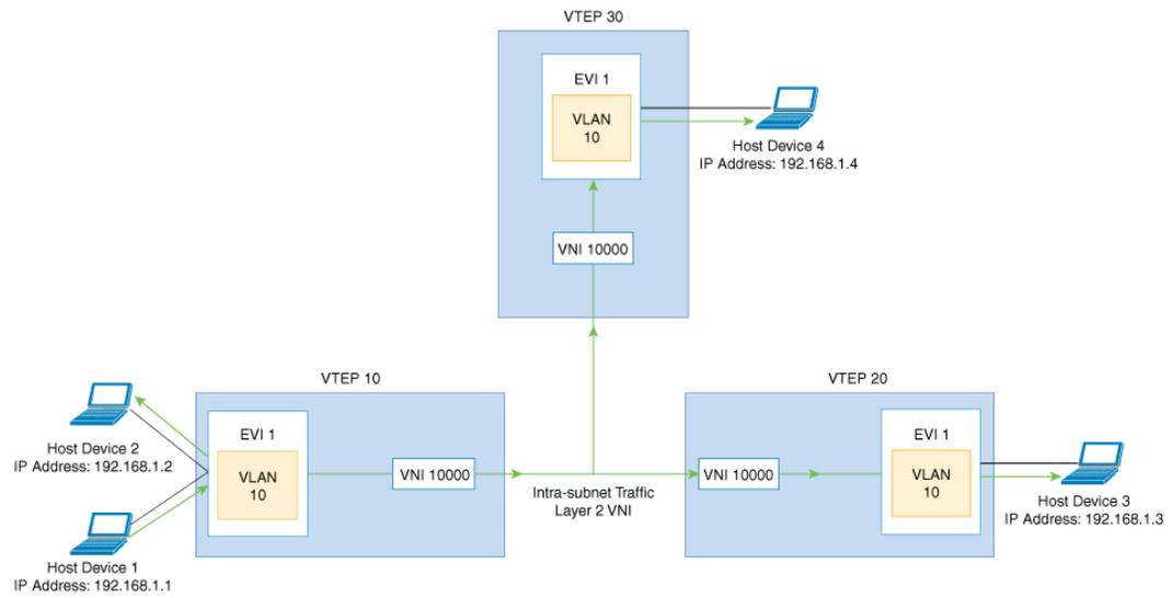
MP-BGP EVPN コントロールプレーンは VXLAN ネットワークで BUM トラフィックの転送に 2 つの異なる方法を使用します。
