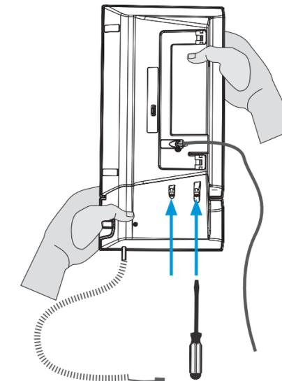
**C** ハンドセットとハンドセットの台座を結合し、ハンドセット ケーブルを接続します。
