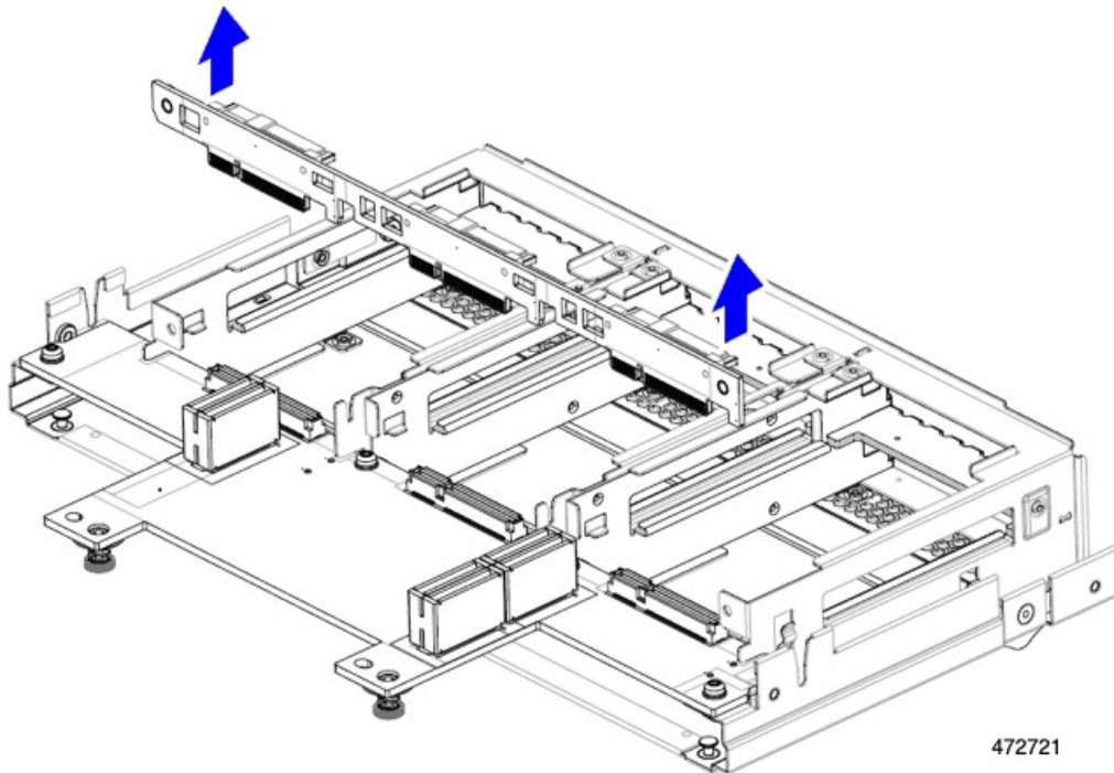
**ステップ3** 板金フレームから PCBA を取り外します。
