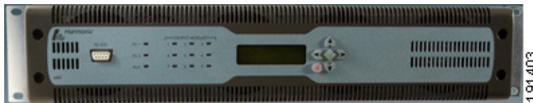
図 2-11 Harmonic NSG 9000 エッジ QAM デバイス
