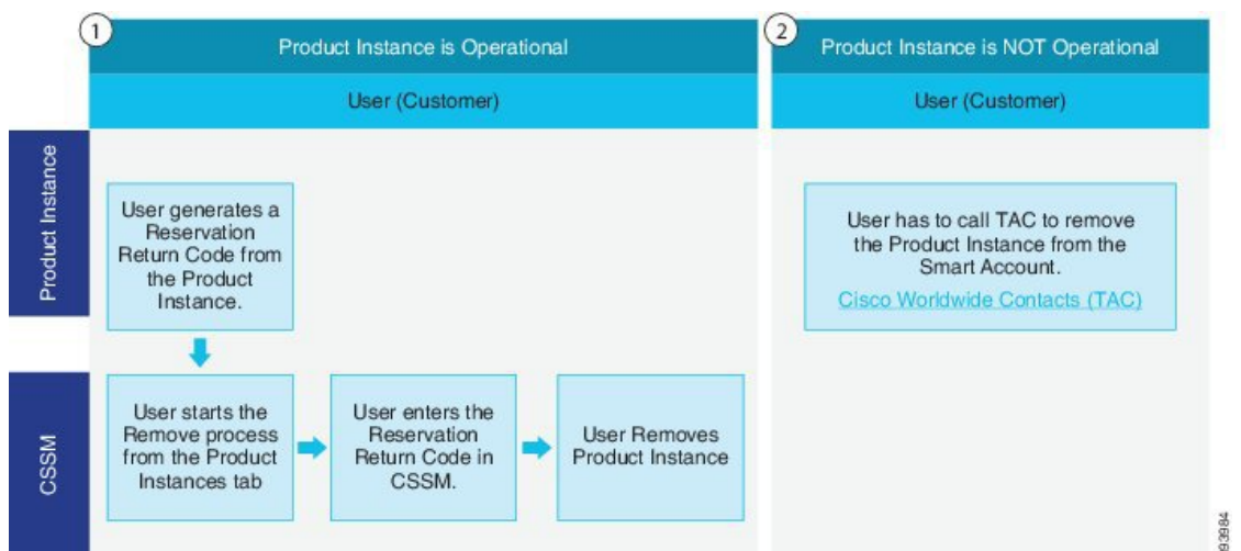
図 3: 製品インスタンスの削除: Unified Communications Manager
