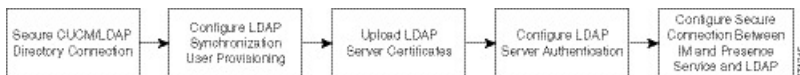
図 11 : Cisco Unified Communications Manager との LDAP ディレクトリの統合のワークフロー
