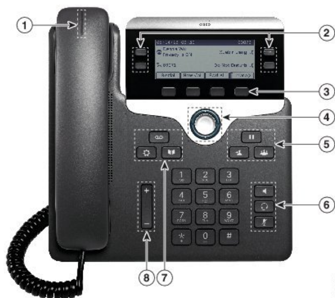
図 3: Cisco IP 電話 7800 シリーズのボタンと機能
