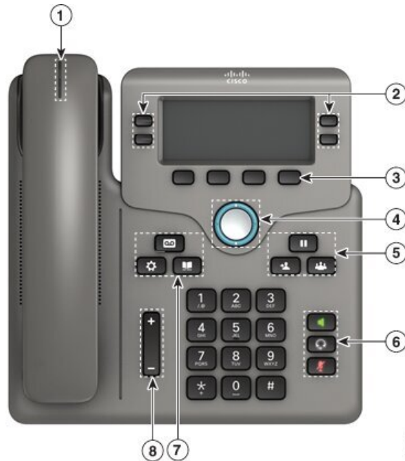
図 4: Cisco IP 電話 6841、6851 および 6861 マルチプラットフォーム電話機のボタンと機能
