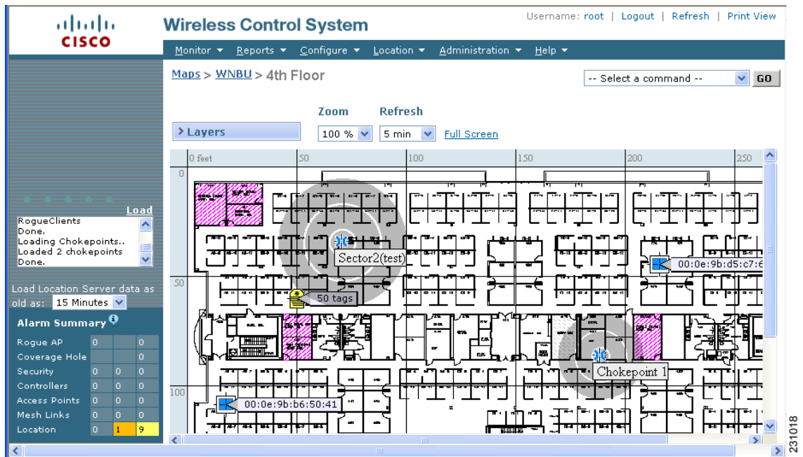
図 7-13 フロア マップ上に表示された新しいチョークポイント
