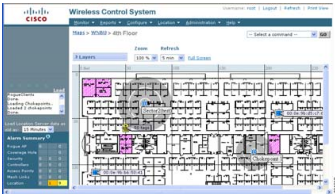
図 7-18 フロア マップ上に表示された新しいチャックポイント
