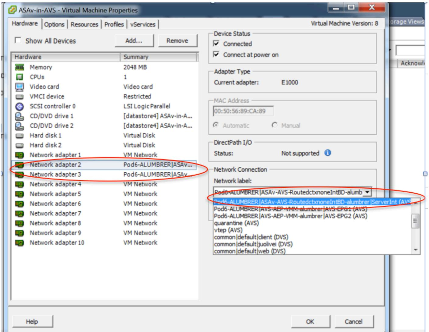
이 테스트에서는 2개의 EPG가 표준 계약과 통신했으며, 이 2개의 EPG는 서로 다른 도메인과 서로 다른 VRF에 있으므로, 두 EPG 간에 경로 누수가 이전에 구성되었습니다. 이는 FW가 2개의 EPG 간에 라우팅 및 필터링을 설정할 때 서비스 그래프를 삽입한 후 약간 감소됩니다. 이전에 EPG 및 BD에 구성된 DG를 이제 계약과 동일하게 제거할 수 있습니다. L4-L7에서 푸시된 계약만 EPG에 남아 있어야 합니다.
