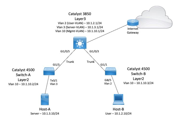
이 다이어그램에서 Catalyst 3850의 소형 샘플 네트워크는 다양한 세그먼트 간의 VLAN 간 라우팅 을 제공합니다. Catalyst 3850 스위치는 IP 라우팅이 비활성화되면 L2 디바이스 역할을 할 수 있습 니다. 스위치가 L3 디바이스로 작동하고 VLAN 간 라우팅을 제공하려면 ip 라우팅이 전역적으로 활 성화되어야 합니다.
