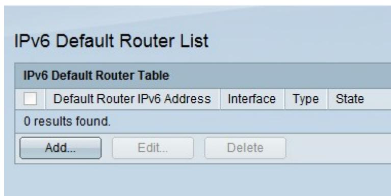
·기본 라우터 IPv6 주소 — 이 매개변수는 기본 라우터의 링크 로컬 IP 주소를 표시합니다.
