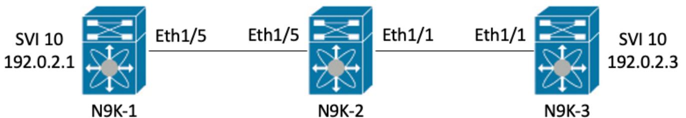
이 예에서는 MTU가 1500바이트인 N9K-3의 인터페이스 SVI 10(IP 주소 192.0.2.3을 소유함)으로 향하는 인터페이스 SVI 10(IP 주소 192.0.2.1)에서 소싱된 점포 크기 8000바이트 ICMP 패킷을 통해 스위치 N9K-1에서 의도적으로 스톱된 CRC 오류가 생성됩니다. N9K-1, N9K-2 및 N9K-3은 모두 Nexus 93180YC-EX 모델 스위치입니다.
