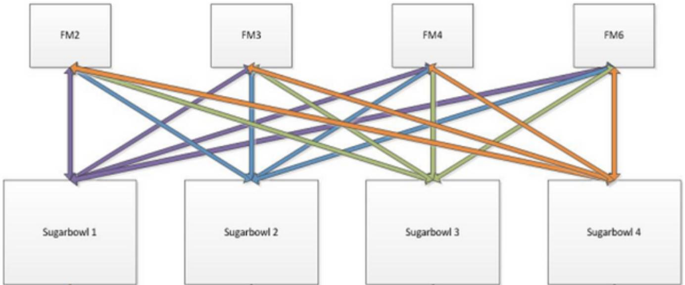
ASIC에서 수신한 트래픽이 다른 ASIC 또는 라인 카드를 이그레스(egress)해야 하는 경우, 해당 트래픽은 패브릭 모듈을 통해 패브릭으로 전송되어야 합니다. 인그레스 ASIC는 패킷 헤더의 해시와 ASIC에 사용 가능한 iEth 링크의 수를 기반으로 패브릭 모듈에 대한 iEth 링크 중 하나를 선택합니다.
