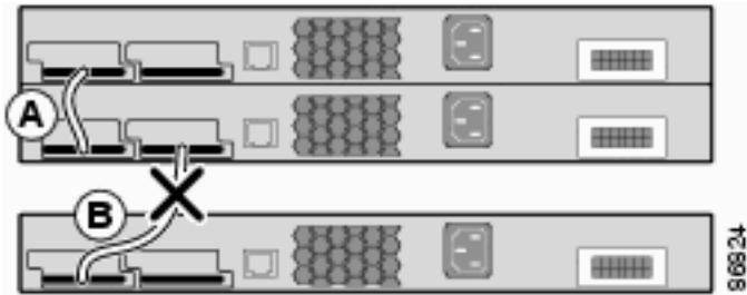
Kabelfouten op één plaats en stapel is verdeeld
