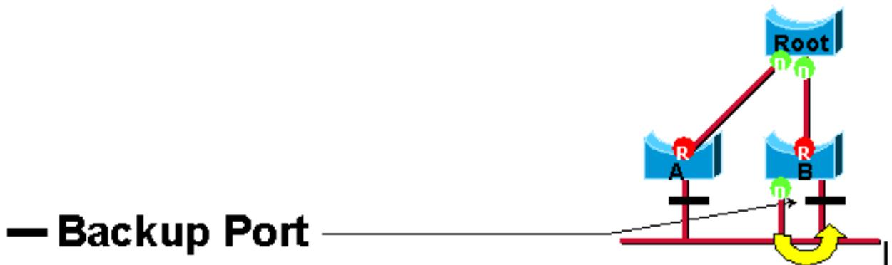
Esta distinção já é feita internamente dentro de 802.1D. Isto é essencialmente como o Cisco UplinkFast funciona. A base racional é que a porta alternada fornece um caminho alternativo ao bridge-raiz e pode conseqüentemente substituir a porta de raiz se esta falha. Naturalmente, uma porta de backup fornece a conectividade redundante ao mesmo segmento e não pode garantir uma conectividade alternada ao bridge-raiz. Conseqüentemente, é excluído do grupo de uplink.
