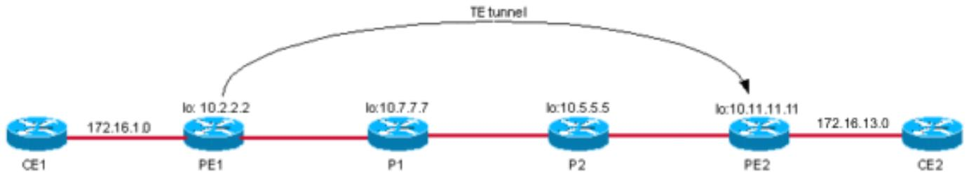
Quando o túnel TE é construído entre os roteadores PE com anúncio de rota automática usado, o salto seguinte do PE de saída BGP pode ser alcançado através da interface de túnel TE. Assim, PE1 usa o rótulo TE para acessar PE2.
