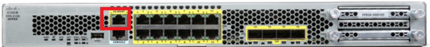
**Observação:** no firepower 2100 Series, a interface de gerenciamento é compartilhada entre o chassi FXOS e o dispositivo lógico FTD.
