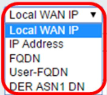
Etapa 7. Escolha na lista suspensa Remote Identifier Type para identificar ou especificar o Internet Security Association and Key Management Protocol (ISAKMP) de seu roteador remoto. As opções são Remote WAN IP, IP Address, FQDN, User FQDN e DER ASN1 DN.
