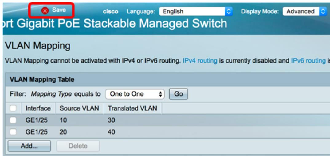
Agora você configurou com êxito as configurações de mapeamento de VLAN Um para um em uma ou mais portas específicas no switch.
