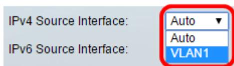
**Nota:** Se a opção Automático for escolhida, o sistema obterá o endereço IP de origem do endereço IP definido na interface de saída. Neste exemplo, VLAN1 é escolhida.
