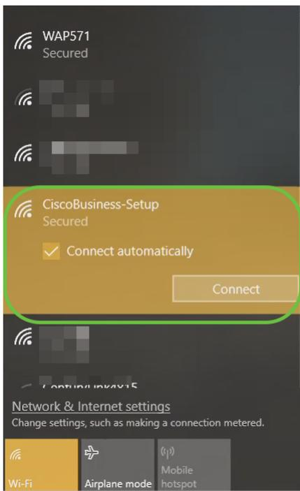
Se o seu ponto de acesso não for novo e pronto para uso, certifique-se de que ele esteja redefinido com as configurações padrão de fábrica para que o SSID de configuração comercial da Cisco apareça em suas opções de Wi-Fi.
