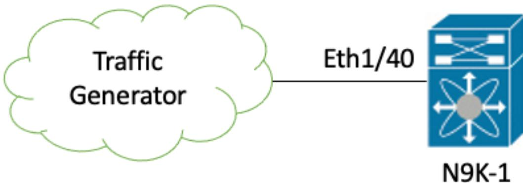
Neste exemplo, um gerador de tráfego conectado à interface física Ethernet1/40 do switch N9K-1 está propositalmente gerando quadros com um CRC incorreto. Isso simula um problema de camada física no link conectado à Ethernet1/40, como um transceptor com defeito ou um cabo danificado. O N9K-1 recebe esses quadros, reconhece que o CRC é inválido e incrementa o contador de erros de CRC na interface física Ethernet1/40. O N9K-1 é um switch modelo Nexus 93180YC-EX.
