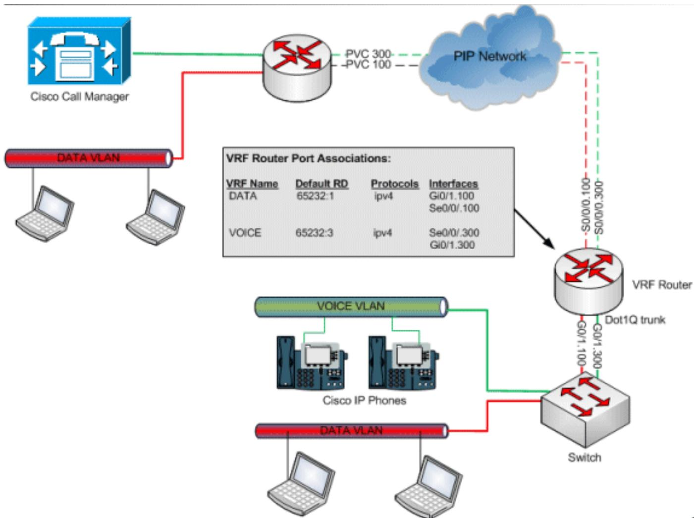
Usando dois roteadores, você pode estabelecer um, ou seja, com o gateway MGCP agindo como um roteador básico (sem VRFs) fornecendo tráfego Ethernet para um segundo roteador que faz o roteamento VRF MPLS. Você pode rotear o tráfego MGCP em um roteador VRF, pois é apenas uma técnica de roteamento e o MGCP não está ciente.
