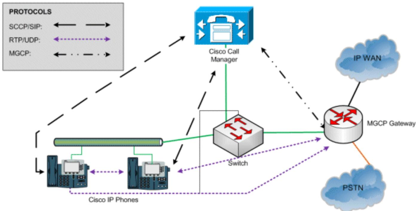
Os telefones IP da Cisco neste exemplo usam o Skinny Call Control Protocol (SCCP) para se comunicar com o Cisco CallManager. Os dados de voz reais são transferidos através do protocolo RTP (Real-time Transport Protocol) diretamente entre os dois dispositivos. O MGCP é usado pelo Cisco CallManager somente para controlar o gateway.
